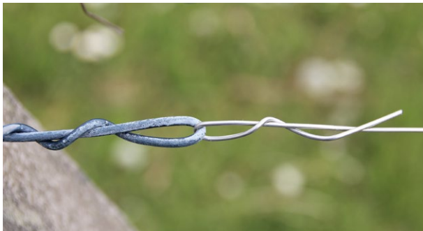
Die Doppelschlinge wird häufig praktiziert. Im Bild wurde ein kunststoffummantelter Draht und ein Edeldraht miteinander verbunden.
