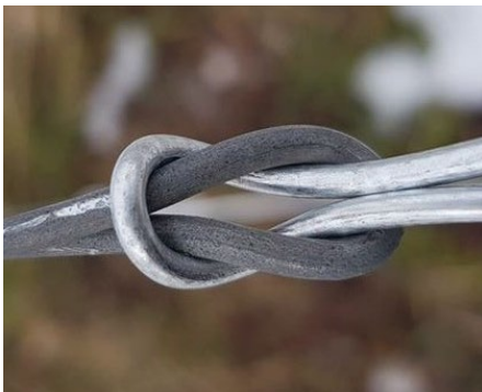
Eine Form der Reparatur des Drahtes ist ein Knoten.
