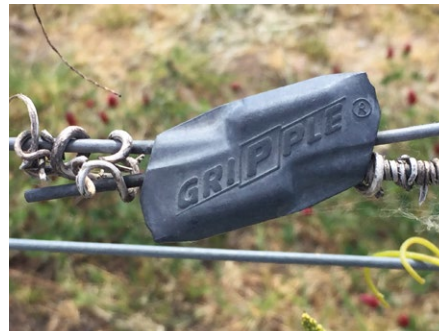
Wird ein Drahtverbinder verwendet, sollte dieser nicht direkt an der Stelle des Stichelhakens platziert werden. Sonst blockiert er beim Einhängen und Spannen.
